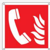
Telefono emergenza antincendio F006
